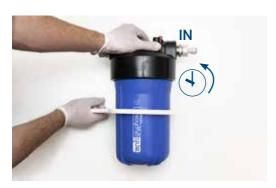
Öffnen Sie das Gehäuse mit Hilfe des Filterschlüssels.
