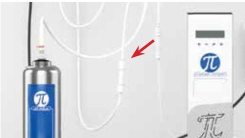
Verbinden Sie das 1/4" T-Stück mit dem mitgelieferten Rückschlagventil 2 (Fließrichtung beachten – siehe Pfeil auf dem Rückschlagventil)
